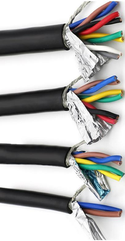
Disponemos de conductores de cobre para tensión AC hasta 1 KV, con construcción apantallada, armada (acero o aluminio en flejes o corona de hilos), armada y apantallada, en formación hasta 5 conductores, con aislamientos XLPE, PVC, Z1, EPR, etc. y sección hasta 630 mm<sup>2</sup>.
