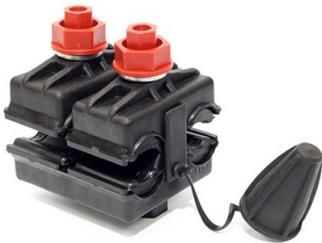
Os nossos conectores efetuam a derivação através da perfuração simultânea do isolamento do condutor da linha principal de distribuição de energia e das linhas secundárias.
